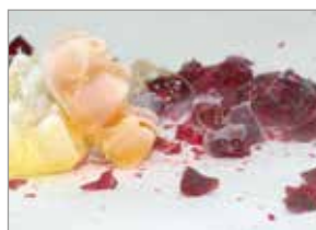
Mit flüssigem Stickstoff versprödetes Probenmaterial
